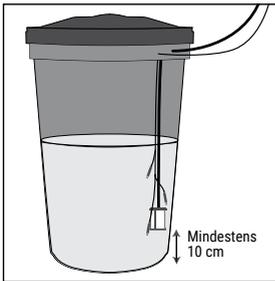
Befestigen Sie den Wasserstandssensor und den Schlauch/Filter mit den mitgelieferten Kabelbindern so, dass sich der mittlere Sensor 2 cm über dem Filter befindet und der untere Sensor unter dem Filter hängt.
